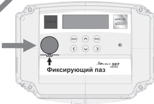
Рисунок 2 – Установка оптоголовки на корпус прибора учета
